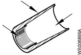
2. Совместите край верхнего регулировочного винта с кромкой верхней конической втулки заподлицо.
