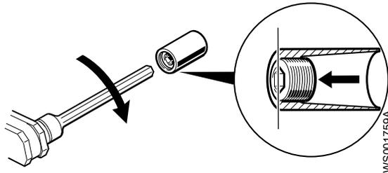
3. Нанесите смазку на резьбу винта и шайбу рабочего колеса.
