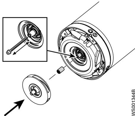
5. Установите верхнюю коническую втулку и верхнее рабочее колесо на вал.
