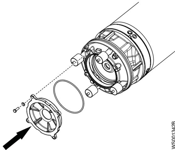
8. Поверните регулировочный винт против часовой стрелки до соприкосновения рабочего колеса с крышкой заборника.
