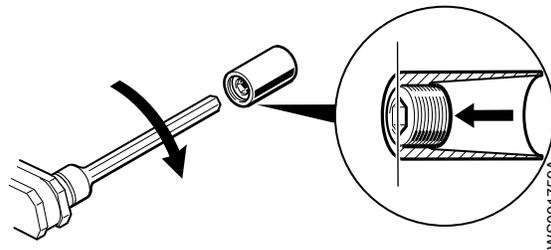
12. Установите нижнюю коническую втулку и нижнее рабочее колесо со стороны вала верхнего рабочего колеса.
